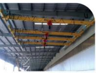
UNDERSLUNG CRANE CAPACITY: Up to 20 ton
