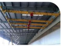
UNDERSLUNG CRANE CAPACITY: Up to 20 ton
